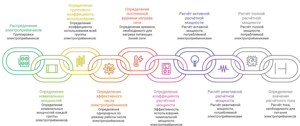
Рис. 4.2. Порядок расчета методом коэффициента расчетной мощности
