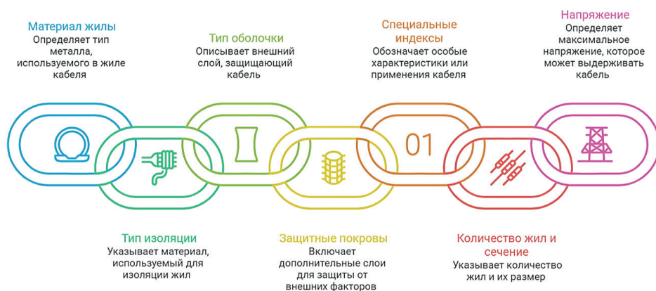
Рис. 4.13. Структура маркировки силовых кабелей, применяемых в сетях промышленных предприятий и предприятий транспорта
