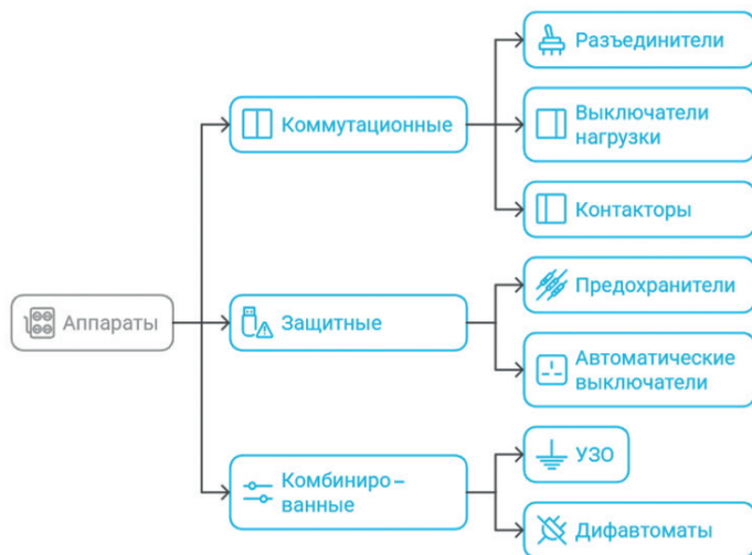
Рис. 4.11. Классификация коммутационных защитных аппаратов 0,4 кВ, применяемых в сетях промышленных предприятий и предприятий транспорта
