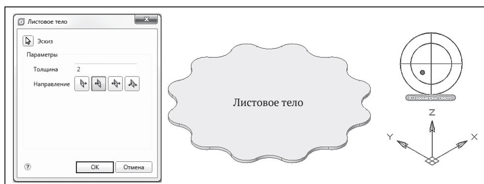
Рис. 3.99. Образование 3D-модели детали «Пластина»
