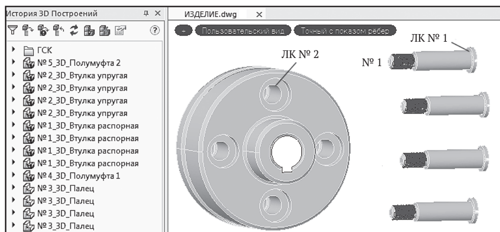
Рис. 4.49. Последовательность выбора круговых ребер в моделях деталей «№ 3_3D_Палец» № 1 и промежуточной сборки изделия
