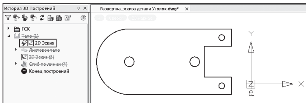
Рис. 3.132. Изображение эскиза развертки поверхности 3D-модели детали «Уголок»
