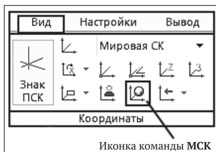
Рис. 2.110. Схема выбора команды МСК (мировой системы координат)
