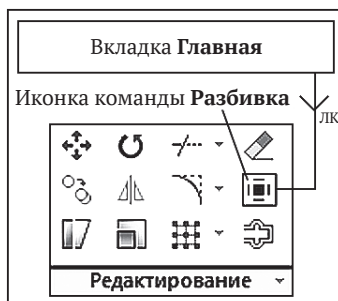
Рис. 5.14. Схема выбора команды Разбивка
