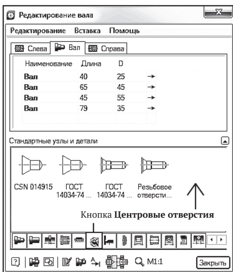
Рис. 5.6. Выбор участков валов кнопкой Центровые отверстия
