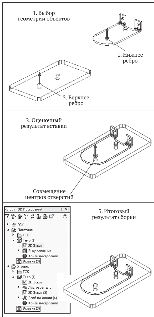
Рис. 4.90. Последовательность вставки двух 3D-моделей деталей
