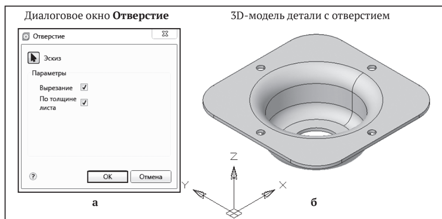
Рис. 3.35. Образование сквозного цилиндрического отверстия в 3D-модели детали «Колпачок»
