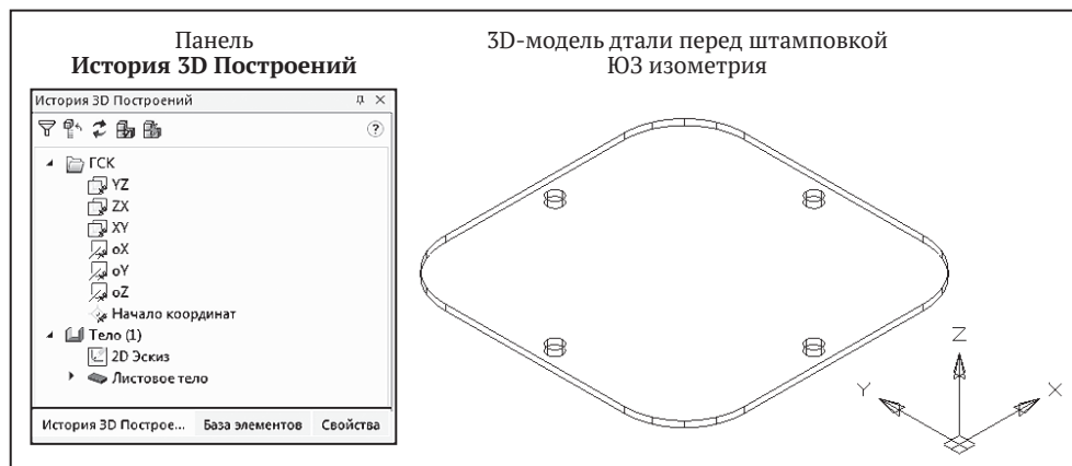
Рис. 3.25. 3D-модель детали «Колпачок» перед штамповкой в ЮЗ изометрии
