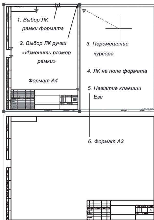
Рис. 5.50. Схема преобразования формата A4 в формат A3
