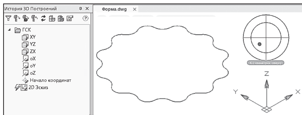
Рис. 3.97. Перевод изображения эскиза контура к виду ЮЗ изометрия, сверху
