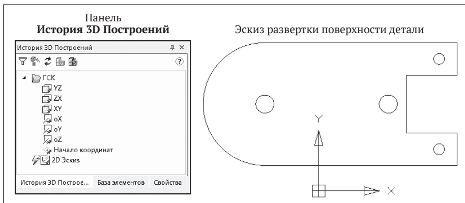
Рис. 3.12. Эскиз развертки поверхности детали «Уголок»
