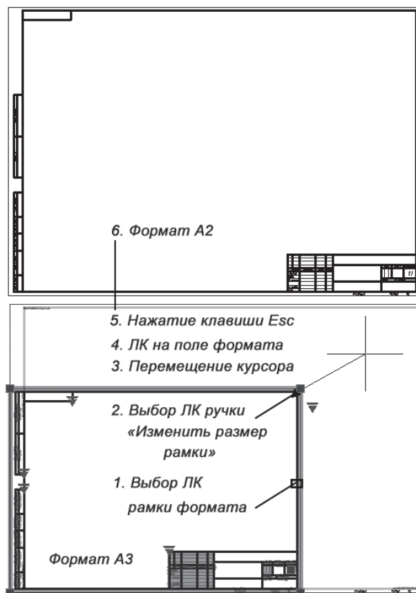
Рис. 5.51. Схема преобразования формата A3 в формат A2
