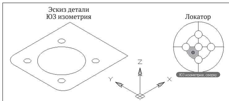
Рис. 3.50. Эскиз детали «Скоба» в ЮЗ изометрии
