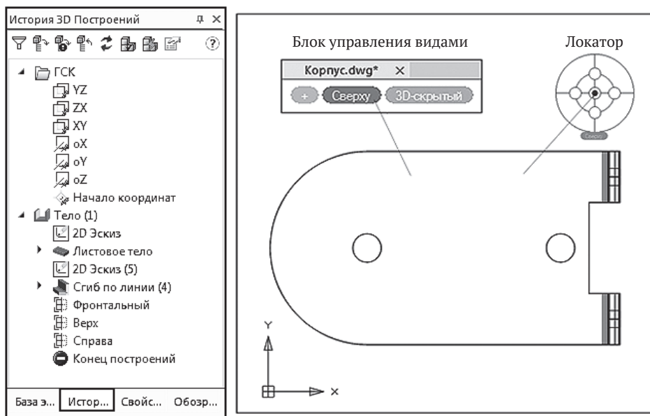
Рис. 3.130. Перевод изображения из ЮЗ изометрии к изображению Вид сверху
