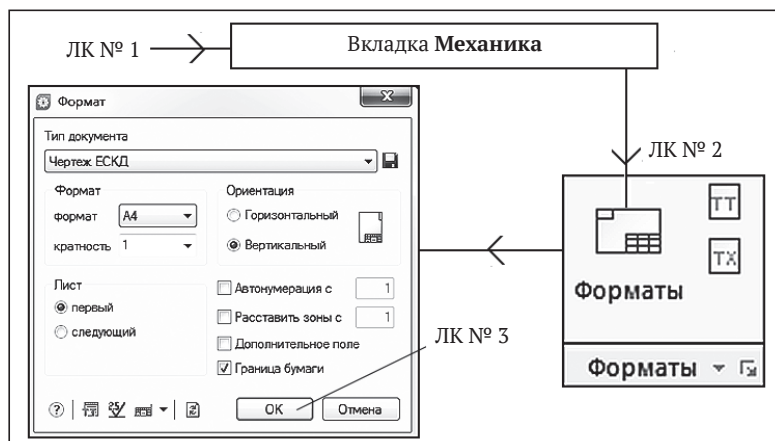
Рис. 3.166. Схема доступа к диалоговому окну Формат
