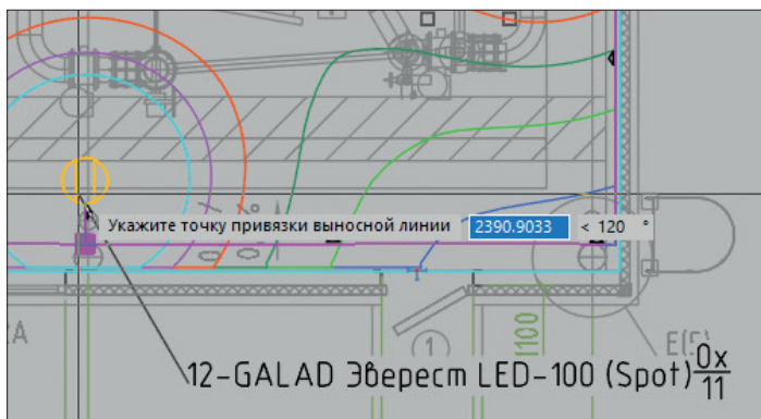
Рис. 3.65. Выбор точки привязки выносной линии
