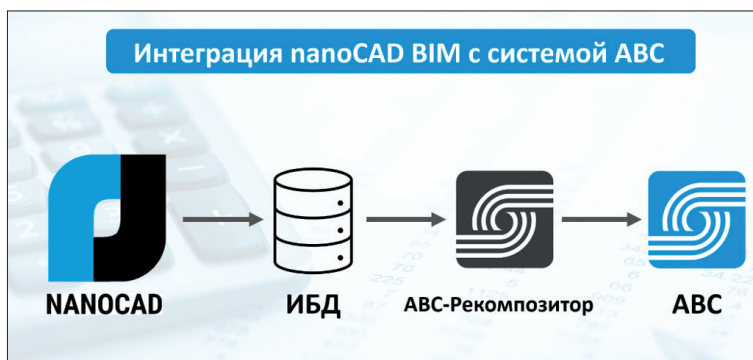
Рис. 5.1. Укрупненная схема интеграции nanoCAD и ABC
