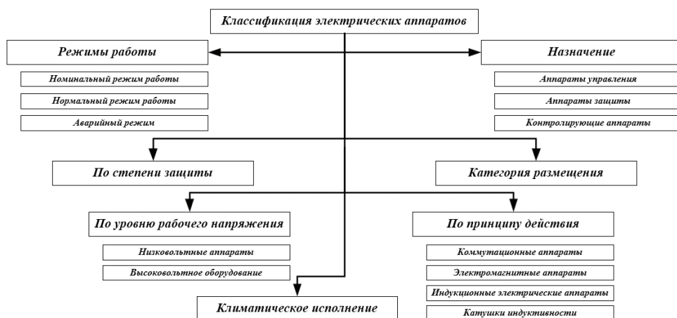
Рис. 2.2.19. Классификация электрических аппаратов
