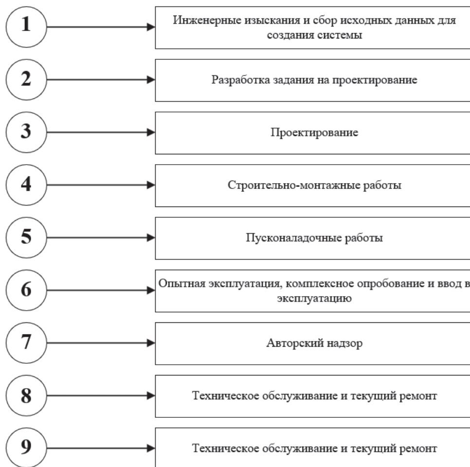
Рис. 1.4. Жизненный цикл инженерных систем
