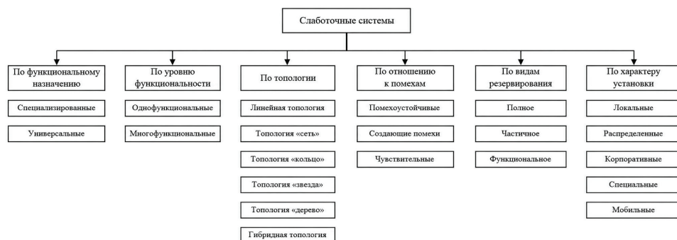
Рис. 4.1.1. Классификация слаботочных систем
