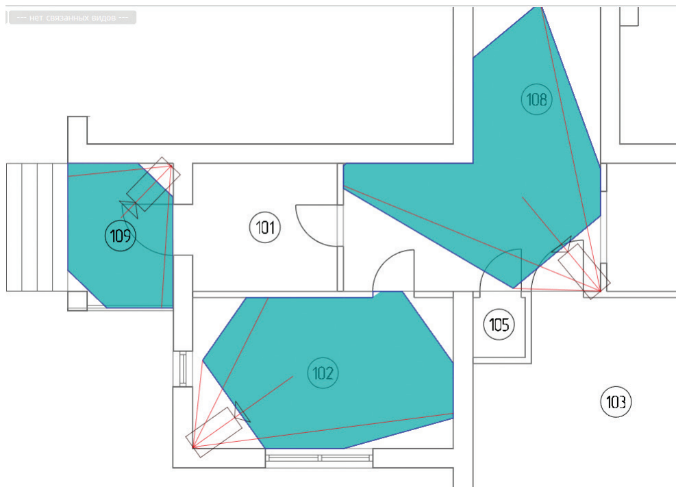
Рис. 3.41. План здания с обозначенными зонами видимости видеокамер
