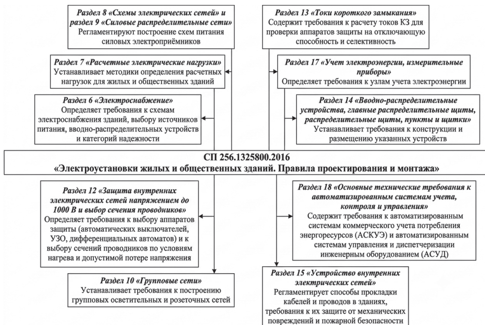
Рис. 2.1.1. Разделы СП 256.1325800.2016, касающиеся проектирования систем электроснабжения
