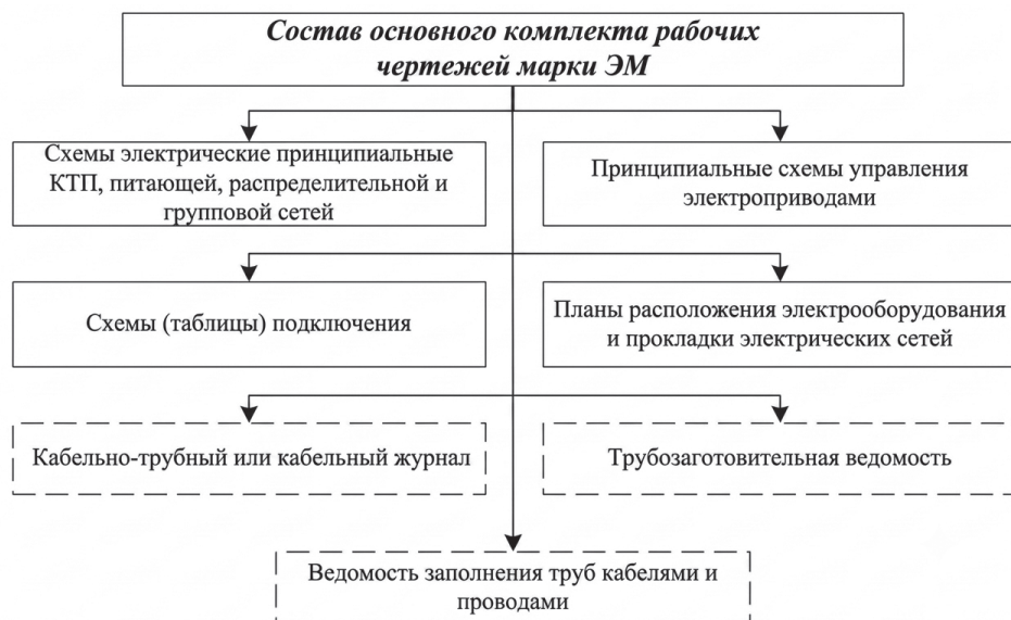
Рис. 2.2.7. Состав комплекта рабочих чертежей марки ЭМ
