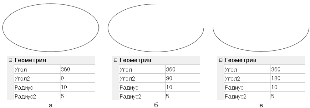
Рис. 3.40 ❖ Скрытие сегментов примитива «Дуга эллиптическая»
