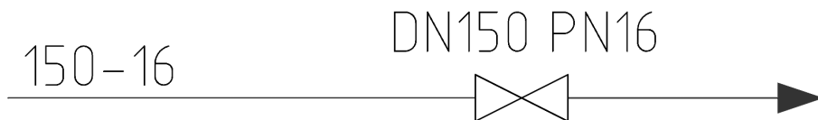
Рис. 8.6 ❖ Наследование параметров трубопроводной арматурой
