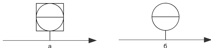
Рис. 2.67 ❖ УГО точки контроля с прямоугольником (а) и без прямоугольника (б)
