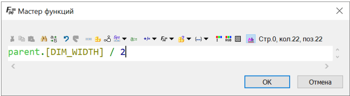
Рис. 5.171 ❖ Параметризация поля «X координата»
