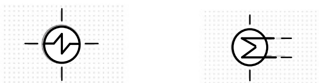
Рис. 5.178 ❖ Универсальные условные обозначения теплообменных аппаратов по стандарту ISO
