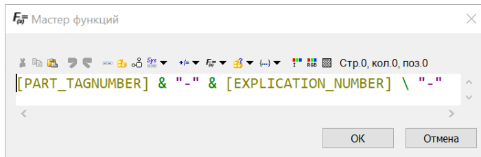
Рис. 3.58 ❖ Пример использования оператора «Строковое вычитание»
