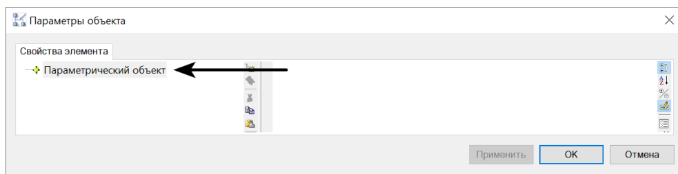
Рис. 4.11 ❖ Исходное окно «Параметры объекта» УГО, созданного с помощью команды «Новое оборудование»
