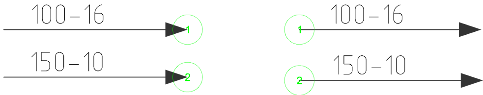
Рис. 10.75 ❖ Создание парных ссылок на сегментах линий трубопроводов
