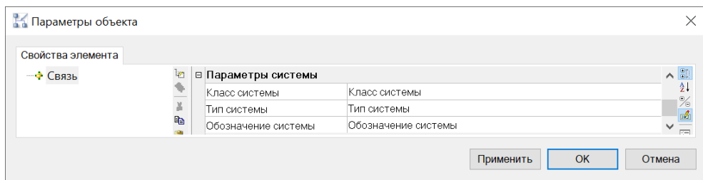
Рис. 11.59 ❖ Пример значений параметров, определяющих систему и подсистему размещения элемента технологической схемы
