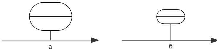
Рис. 2.71 ❖ Изменение формы и размеров УГО «Точка контроля»
