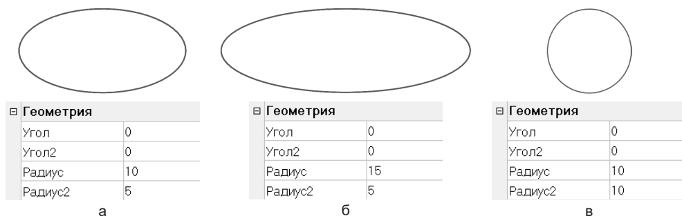
Рис. 3.38 ❖ Изменения размера примитива «Дуга эллиптическая» в зависимости от изменения значений в полях «Радиус» и «Радиус2»
