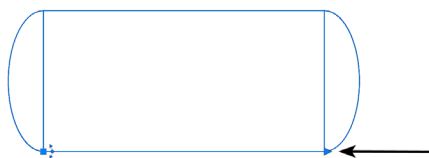
Рис. 5.43 ❖ Визуализация ручки изменения длины
