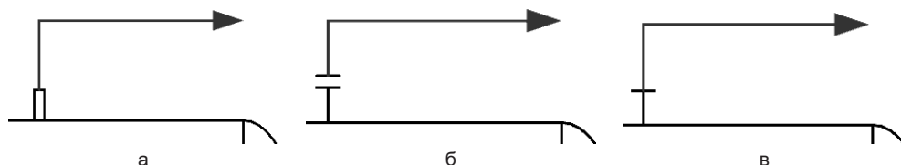
Рис. 2.22 ❖ УГО штуцеров, размещаемых при трассировке линии трубопровода
