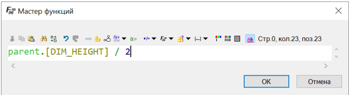
Рис. 5.172 ❖ Параметризация поля «Y координата»
