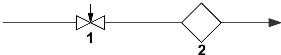
Рис. 4.1 ❖ Размещение Inline-элементов на линии трубопровода
