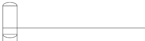
Рис. 5.91 ❖ Прямоугольный массив и графический примитив «Отрезок» с параметрами по умолчанию
